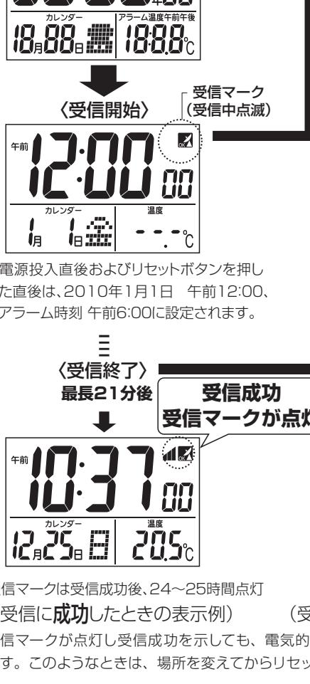
※電源投入直後およびリセットボタンを押した直後は、2010年1月1日 午前12:00、アラーム時刻 午前6:00に設定されます。
