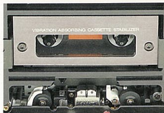
セラミック・テープガイドを新採用したトランスポートメカニズム
