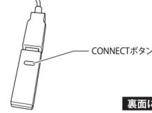
②裏面にあるON/OFFスイッチをONにし、CONNECTボタンを押します。
